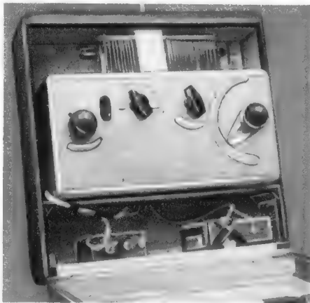
Bild 6. In den Koffer eingesetzter Empfänger bei heruntergeklapptem Kofferdeckel
