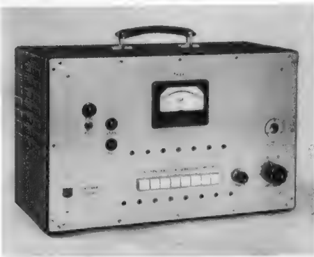
Leistungs-Meßsender MS 50 mit acht Festfrequenzen (Klein & Hummel)
